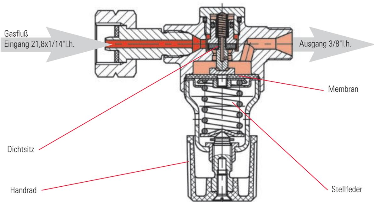
Der Regler (Druckminderer) ist eine membran gesteuerte Regeleinheit, die einen variablen Flaschendruck in einen konstanten Arbeitsdruck reduziert. Über ein Handrad kann der benötigte Arbeitsdruck eingestellt werden. Einstellbare Regler müssen ein Manometer oder eine Skalierung an der Einstellschraube zwingend vorweisen (Forderung nach DIN 4811).
