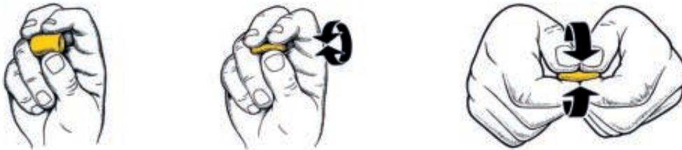
1.) Vor dem Einsetzen Gehörschutzstöpsel mit sauberen Fingern zu einer dünnen Rolle formen.
