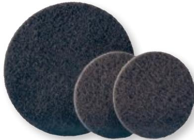
Reduzierung des Durchschleifens bei dünnwandigem Material · keine Formveränderung der Scheibe · universell verwendbar · zum Reinigen und Entrosten, Abschleifen von alten Lackschichten und Steinschlagschutz, Feinentgratung, Anschleifen von Metalloberflächen, Entfernen von Anlauffarben und Schweißrückständen u. v. m. · **kletthaftend**
