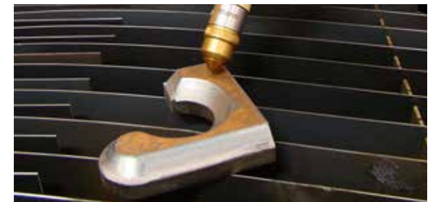
Das Schneidergebnis ist aufgrund der höheren Steifigkeit des Systems im Vergleich zum Roboter äußerst präzise.
