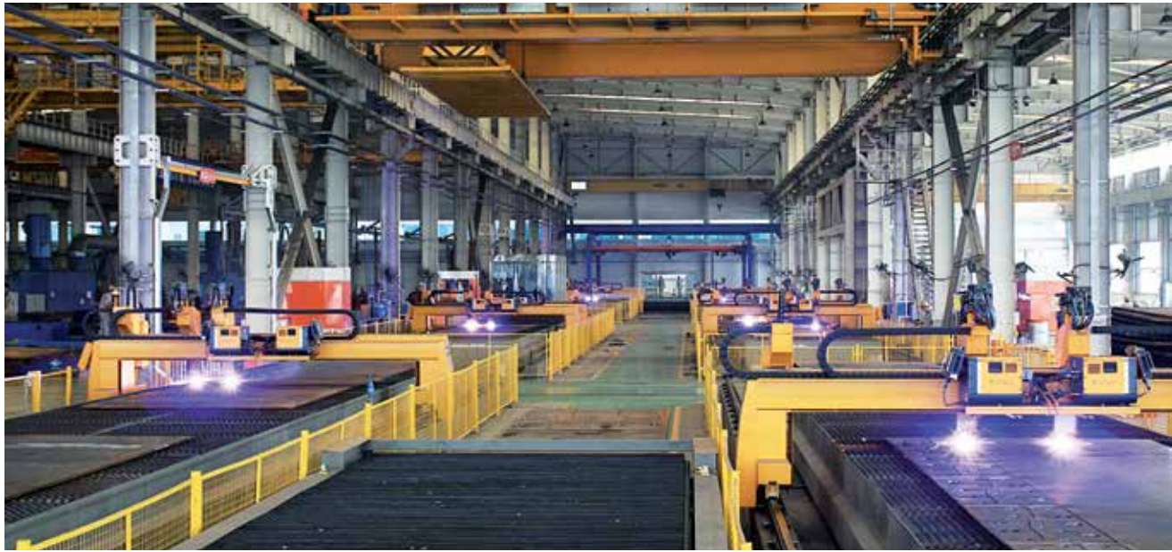
24/7 im Betrieb: Die Produktionslinie (Bild links) bei einem chinesischen Maschinen- und Anlagenbauer wird von einem zentralen Leitstand (Bild oben) aus gesteuert. Insgesamt acht CNC-Plasmaschneidanlagen von MicroStep werden dabei automatisiert von einem Demag-Prozesskran beladen.
