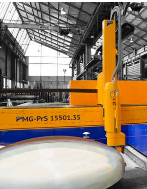
Die mSCAN-Technologie von MicroStep ermöglicht höchste Präzision bei der Behälterbodenbearbeitung. Ein auf dem Portal integrierter Laserscanner ermittelt dabei vorab die tatsächliche 3D-Oberflächengeometrie des Werkstücks.
