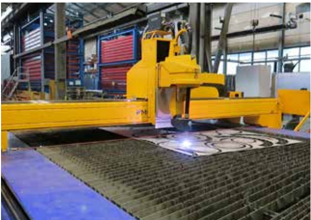
Die GEA Production Kitzingen hat sich für eine multifunktionale MG Plasmaschneidanlage entschieden, mit der sowohl Bleche als auch Behälterböden bearbeitet werden können.
