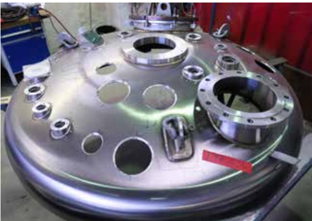
Rund eineinhalb Wochen betrug die typische Durchlaufzeit bei komplexen Behälterböden mit vielen Stützen (siehe beispielsweise Foto oben) – heute kann GEA bei Bedarf in einem Tag produzieren.
