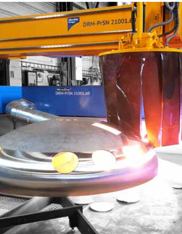
Die mSCAN-Technologie von MicroStep ermöglicht höchste Präzision bei der Behälterbodenbearbeitung. Ein auf dem Portal integrierter Laserscanner ermittelt dabei vorab die tatsächliche 3D-Oberflächengeometrie des Werkstücks.
