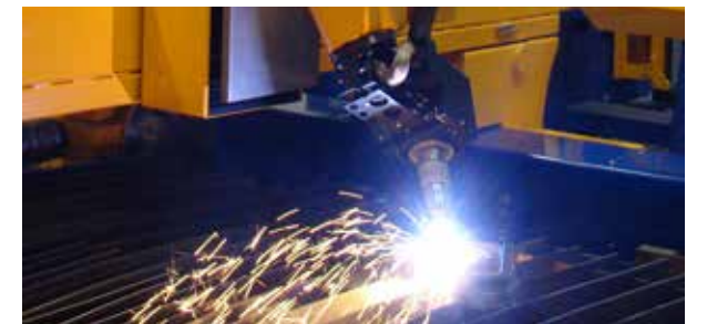
Mit dem endlosdrehenden Rotator können dann V-, Y-, und unter bestimmten Bedingungen sogar X- und K-Fasen nachträglich angebracht werden.
