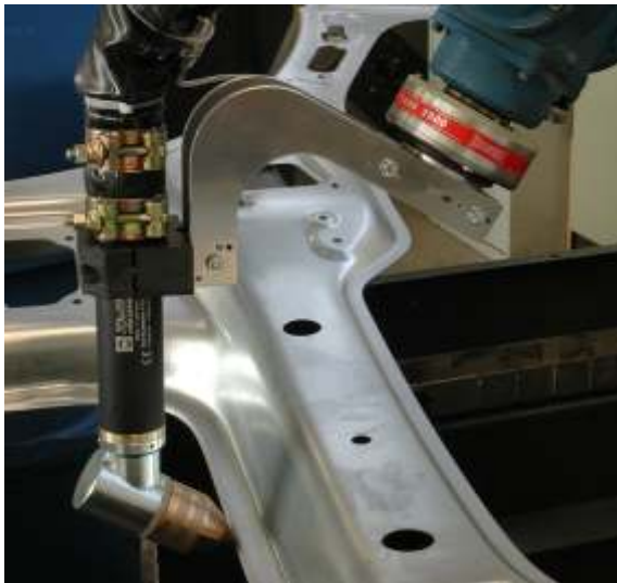
Gratfreies Ausschneiden eines Fensters an einer Pkw- Seitenwand mit 4,0 m/min (verzinkter Stahl 1mm)
