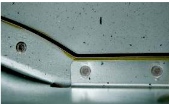
Schmale und saubere Schnittfuge an einer verzinkten Pkw-Karosserie; Vorzug: Keine verbrannte Zinkschicht entlang der Plasmafuge
