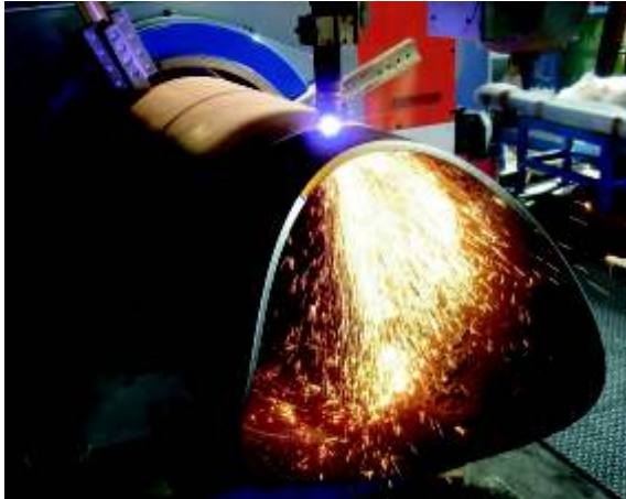
Ablängen und Schneiden von Öffnungen an Rohren
