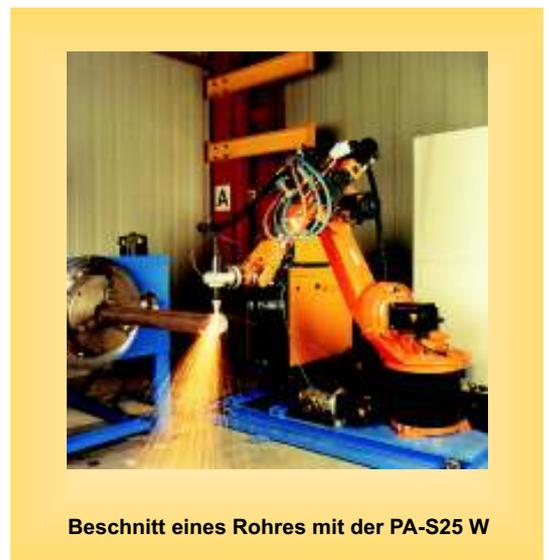
Beschnitt eines Rohres mit der PA-S25 W
