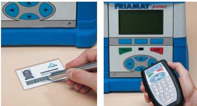
Mit der **Infrarot-Fernbedienung** ist die Bedienung der Geräte „aus der Ferne“ möglich. Alle Funktionen, die Sie direkt am Gerät ausüben können, steuern Sie nun durch Infrarot-Befehle. Besonders geeignet ist dieser nützliche Helfer, wenn Sie viel mit Kommissionsnummern und Infotext arbeiten, da für die Dateneingabe eine komfortable Tastatur zur Verfügung steht.
