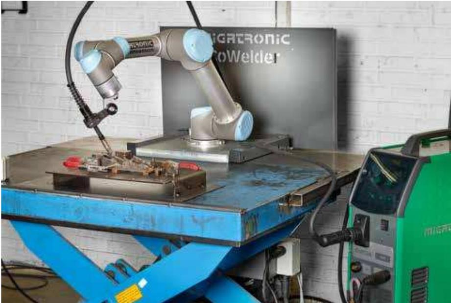
Die komplette Schweißroboter-Lösung passt auf jeden Werkstatt-Tisch. Die flexible, leichte Installation ist leicht beweglich.
