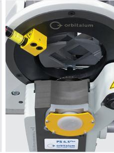
Zweite Sägeblattaufnahme zum Herausstrennen von Rohrbögen
