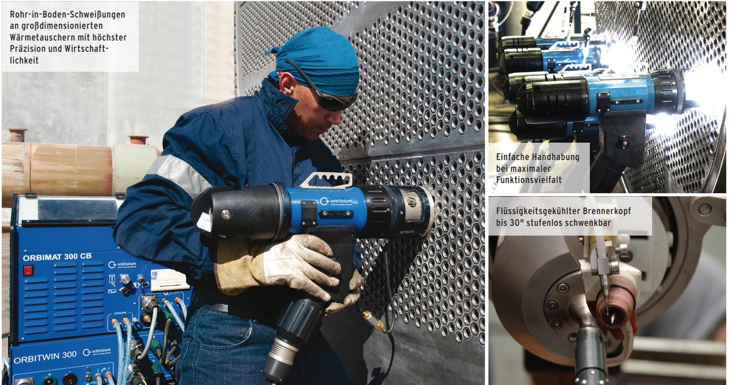
Rohr-in-Boden-Schweißungen an großdimensionierten Wärmetauschern mit höchster Präzision und Wirtschaftlichkeit
