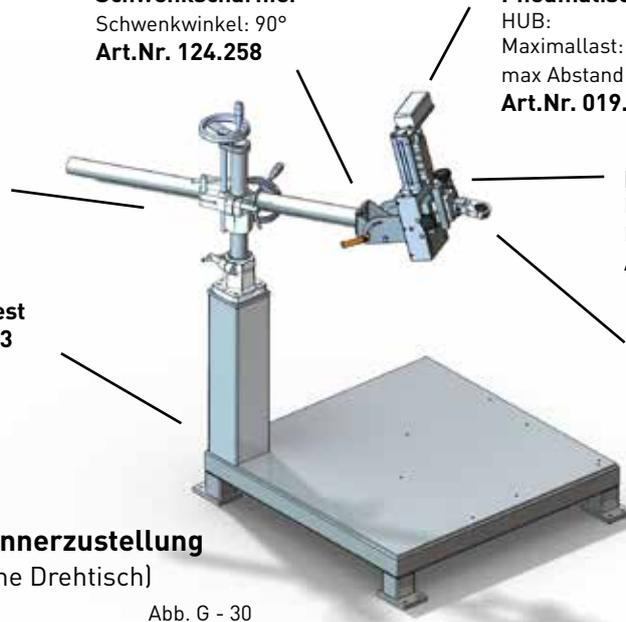
**A Anlagenpodest mit pneumatischer Brennerzustellung Typ Z-0006-598 (ohne Drehtisch)**
