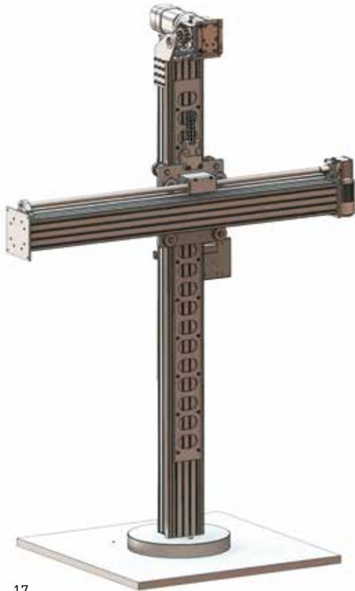
Der Automatenträger besteht aus 2 leichtgängigen Führungen für die Vertikal und Horizontalzustellung. Sie werden über 2 Drehstrommotoren angetrieben. Die Endposition kann über die Steuerung im Bediengehäuse mittels Joystik oder über eine Funk-Fernbedienung angefahren werden.
