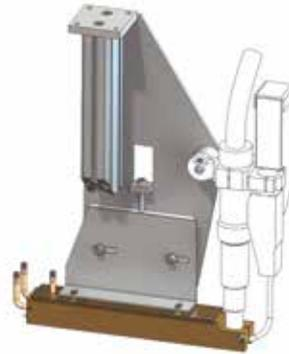
Abb. H - 40 Formiergas-einrichtung Decklage Ausführung Plasma (s. Kapitel F Seite F - 3)
