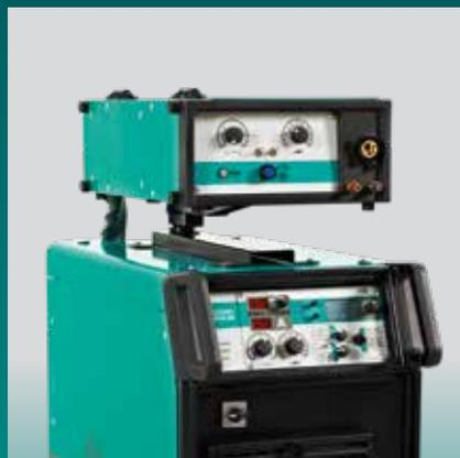
Waagerechte Montage des Drahtvorschubgeräts.
