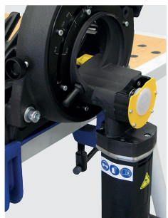
Inklusive zweite Sägeblattaufnahme zum Heraustrennen von Rohrbögen
