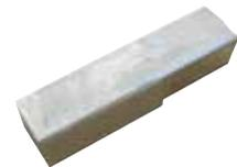
Früherer Standard-HSS-Drehstahl 9,5 x 9,5 mm
